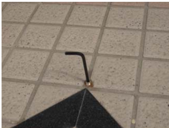
2. 後地平螺栓內止付螺絲， 以內六角扳手拆除。
